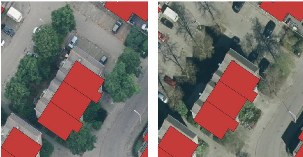
Figuur 19: Visualisatie van het hellende effect, het schaduw effect en het effect van overhangende bomen op de luchtfoto van 2024 (links, bewolkt) en 2023 (rechts, zonnig). De rode vlakken geven de BAG registratie van panden aan, wat de locatie van het pand op het maaiveld aangeeft. Daardoor is duidelijk zichtbaar dat een deel van de omgeving van het pand wegvalt door de hoek waarin de luchtfoto is genomen. Ook is er veel niet zichtbaar door de overhangende bomen en geeft de luchtfoto rechts ook een duidelijk beeld van het schaduw effect.
